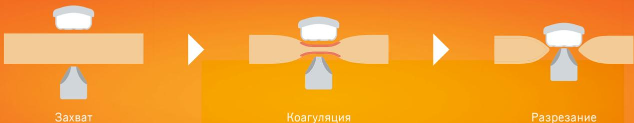
Сила нажатия на рычаг имеет непосредственное влияние на скорость сечения ультразвукового скальпеля LOTUS.
