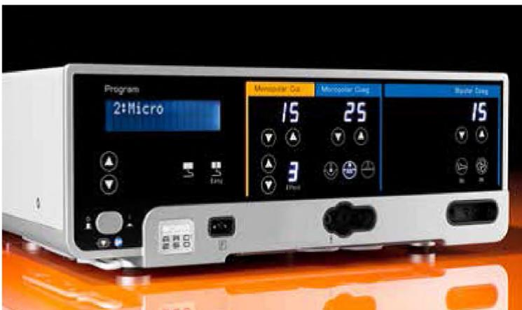
Аппарат ARC 250 работает во всех стандартных электрохирургических режимах и обладает такими полезными функциями, как функция автозапуска (AUTOSTART), функция обеспечения безопасности, т.е. контроля нейтрального электрода (EASY), а также интегрированным накопителем сбоев и системой постоянной самодиагностики (ISSys).
