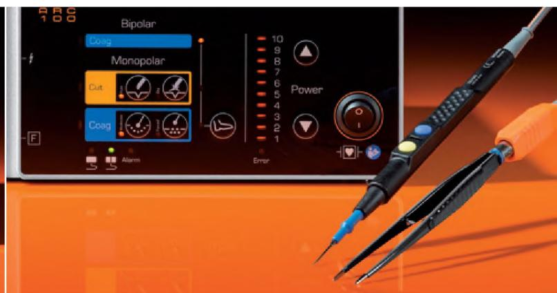
Двойная функция – все всегда на виду: ARC 100 с разъемом для кабеля монополярного и биполярного применения.
